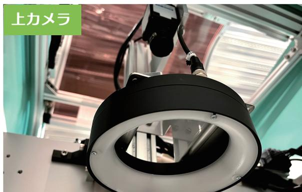
照明の方向を高速で切り替えて撮像し、欠陥をより見えるようにします。
